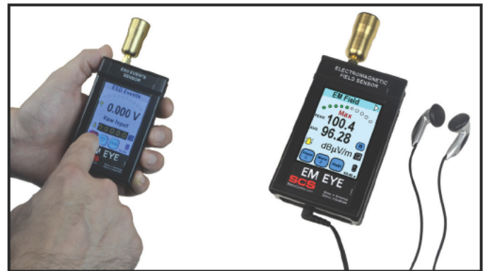
Figure 2. Using the EM Eye Meter
