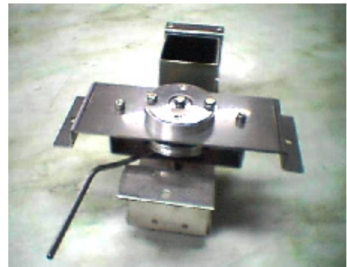
Lotpumpeneinheit mit optionaler Stickstoffzuführereinheit / Solder pump unit with optional nitrogen supply unit
